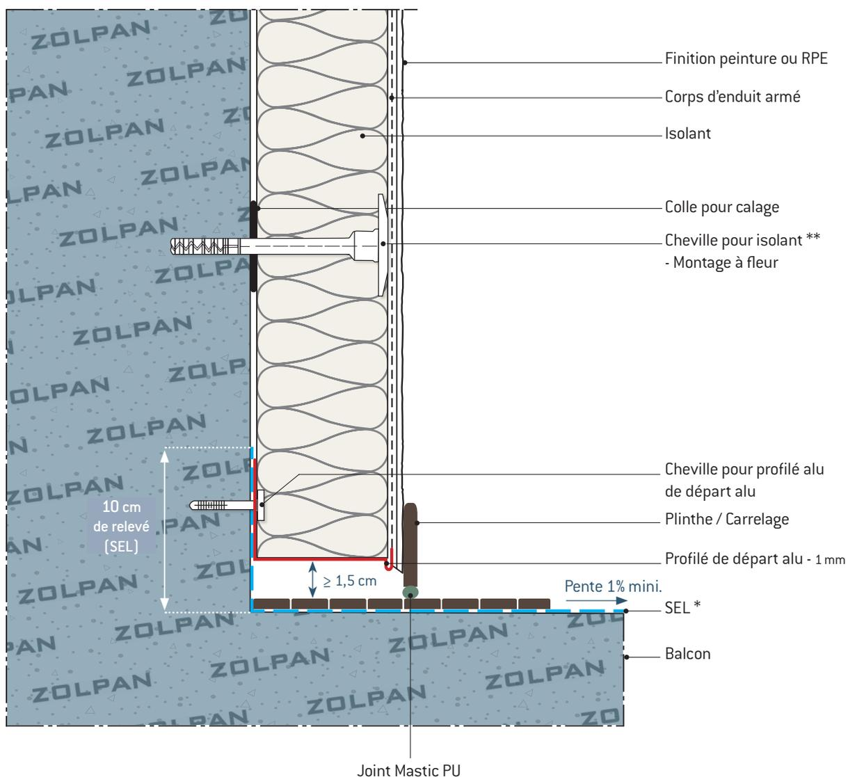
\* Système d'étanchéité liquide horizontale.
