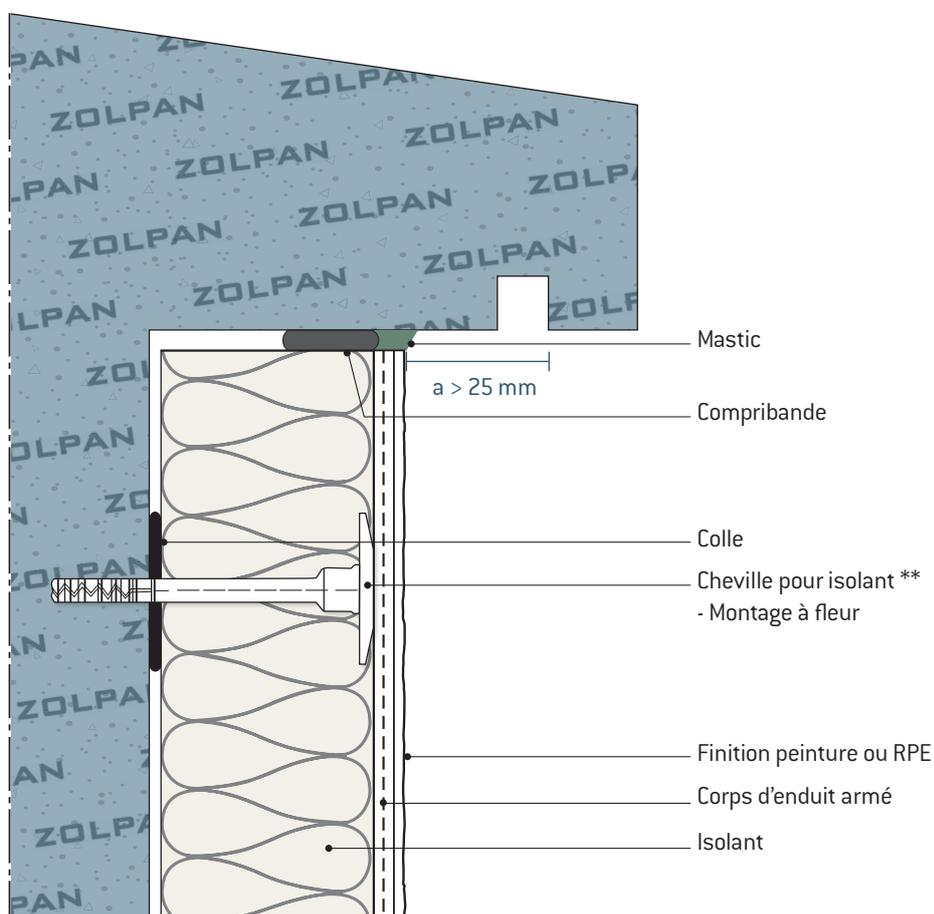
\*\* Pour isolant laine minérale, et dans les cas de rénovation avec isolant PSE.
